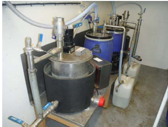
Figur 1b. 35-liters rötkammare för enstegsrötning. Användes för rötning av konservärtshalm-
